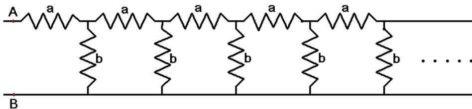
因為右邊的有無窮多個電阻，所以除了左邊的兩個電阻之外，右邊的電阻會等於總電阻，設總電阻為 x，利用電阻的串、並聯的計算原則，可得方程式：(如下圖)
